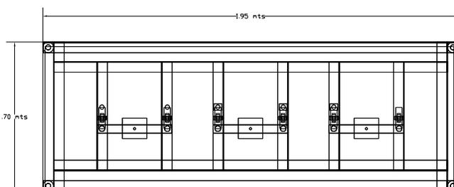
Banco para ensaye triaxial de deformacion controlada para 3 camaras triaxiales con puente de aplicacion de cargas balanceada con poleas con altura ajustable soportes autonivelantes y doble juego de niveles
